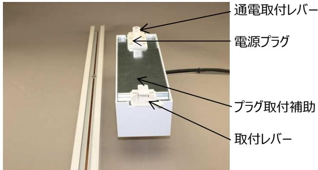
電源プラグとP<sup>+</sup>ラグ 取付補助が左記写真のようにダクトレールの溝と水平になっている事を確認してください。
